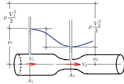
图 9 文丘里流量计原理 (伯努利方程在管流中的应用)
