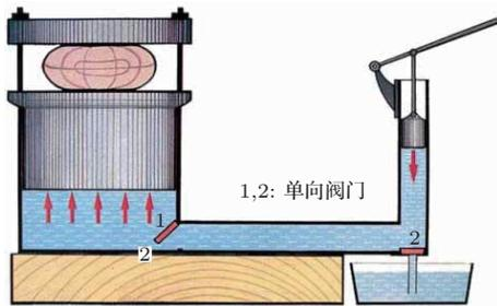
图 4 水压机原理
