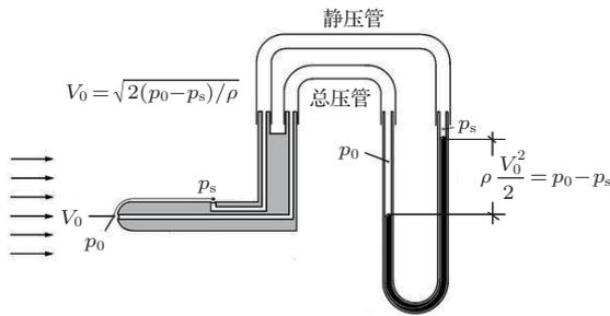
图 7 普朗特风速管 (皮托管测速仪)
